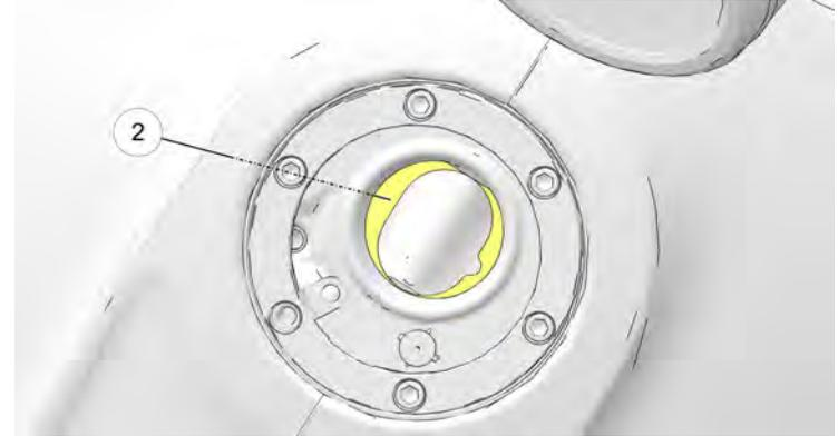
2. Inserte la boquilla de combustible dentro del cuello de llenado del tanque de combustible.
